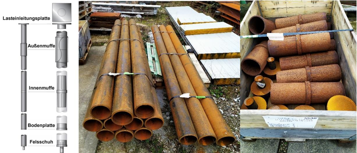
**Abbildung 5-5: Stahlpfahlkomponenten, links: Skizze der Bestandteile von Rammpfählen [107], Mitte: Stahlrohre, rechts: Verbindungsmuffen und Abschlussplatten**
