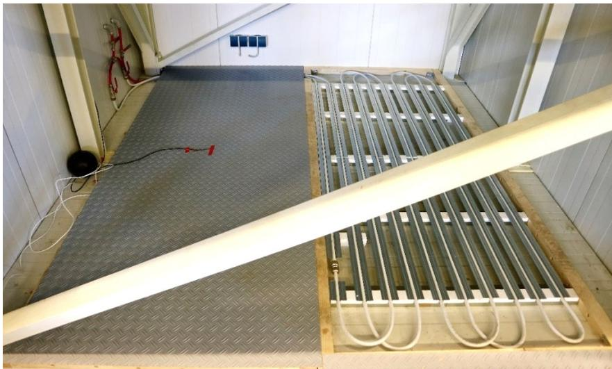
**Abbildung 3-13: Integriertes Fußbodenkühlsystem im thermischen Leistungsprüfstand**
