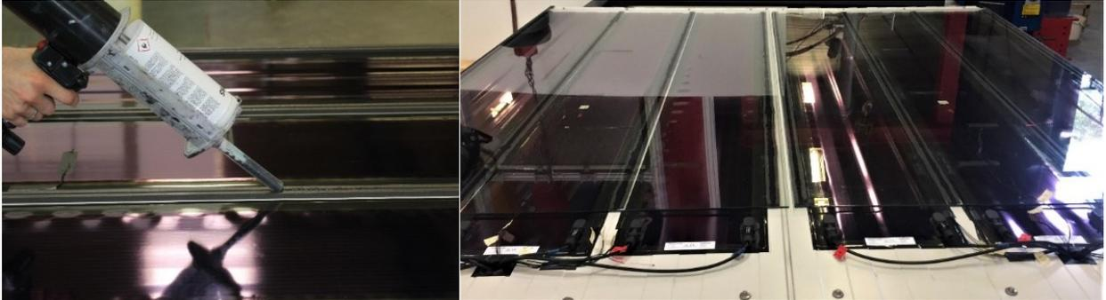
**Abbildung 4-14: Montage der Glasscheiben, links: Einbringen des Silikonklebers, rechts: aufgeklebte Glasscheiben am Demonstrator A**
