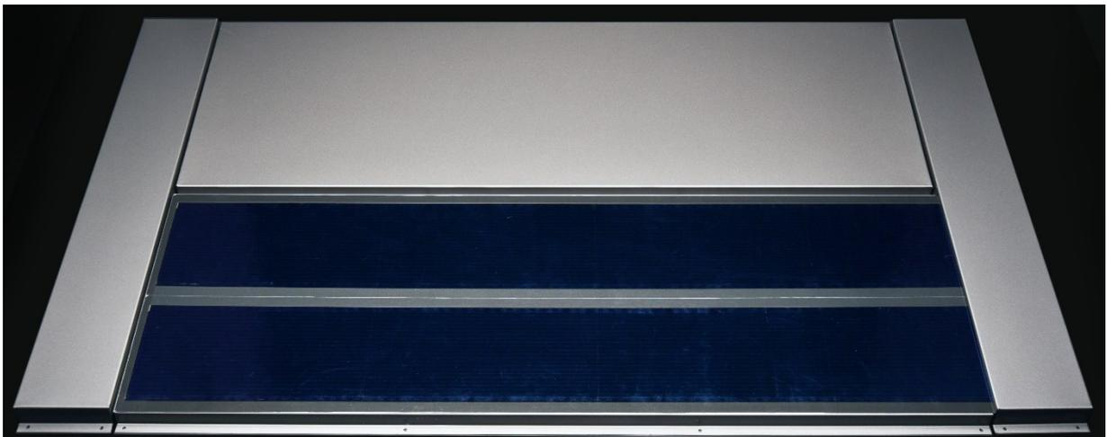
**Abbildung 4-3: Anordnung der Paneele für den solarthermischen Demonstrator, oben: thermisch aktiviertes Panel mit Absorberleitungen auf der Rückseite, unten: Kombikollektor mit OPV [76]**
