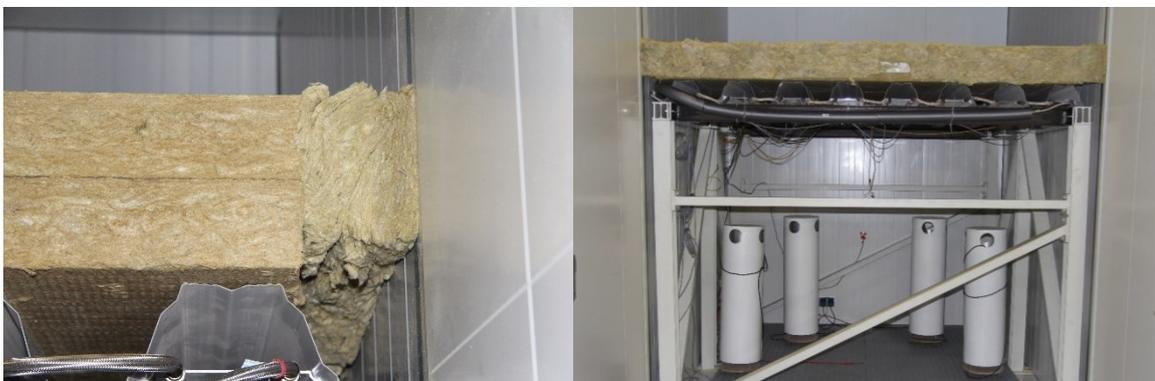
**Abbildung 3-14: Eingebauter Demonstrator im thermischen Leistungsprüfstand, links: thermische Trennung zum oberen Prüfraum mittels Mineralwollplatten, rechts: Ansicht nach Montage der Sensoren**
