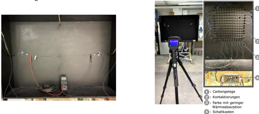
Bild 2 4-Punkt-Messung zur Bestimmung des spez. Carbonwiderstands (links), 2-Punkt-Messung zur Wärmeverteilung der Carbongelege exemplarisch für C-EP (rechts)
