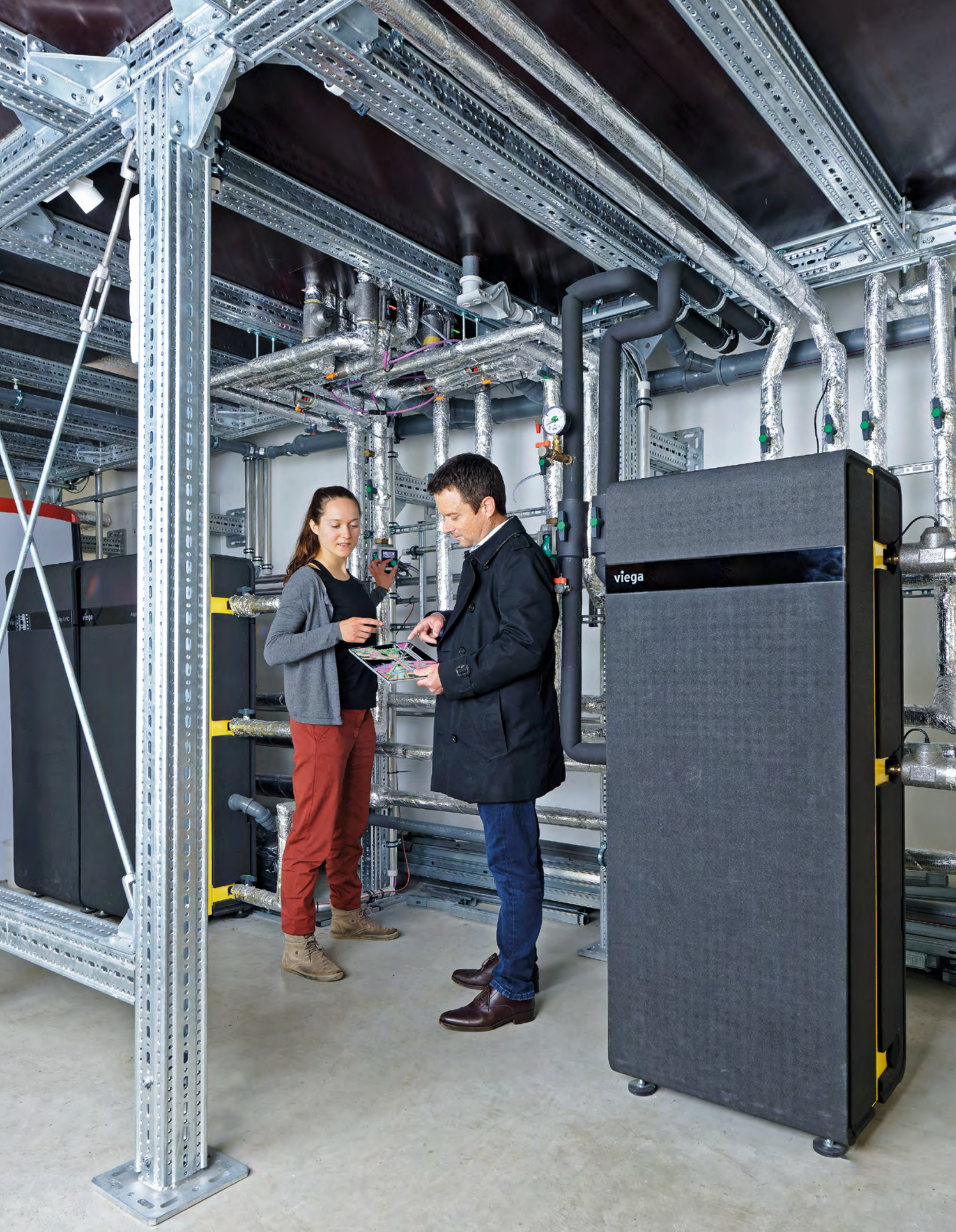
Bild 1: Betriebsdatenmonitoring am Prüfstand „Viega Cube“ zum Trinkwassermanagement in der Versuchshalle des Lehrstuhls für Energieeffizientes Bauen
