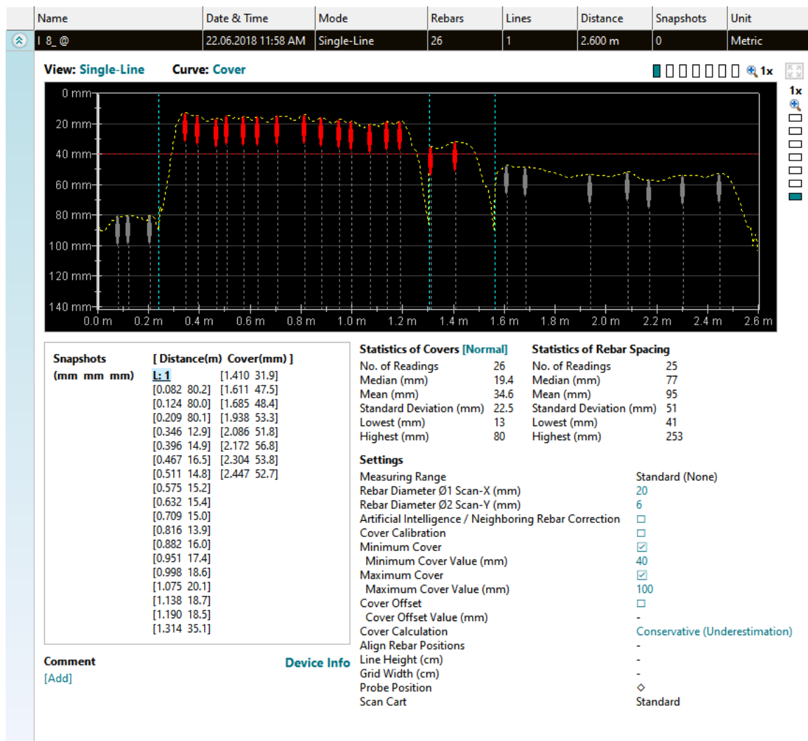
Abbildung 2.14: Darstellung und Auswertung einer Betondeckungsmessung in der Software Profometer Link
