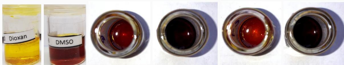
**Abbildung 3-4:** Farbverschiedenheit ausgewählter Lösungen von [von links nach rechts] *e*-(H<sub>4</sub>)CIDA (**6e**) in Dioxan bzw. DMSO, *e*-(H<sub>4</sub>)CICA (**11e**) in DMSO bzw. Aceton und *p*-(H<sub>4</sub>)CICA (**11e**) in DMSO bzw. Aceton.
