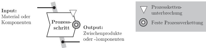
Abb. 2.5: Schemadarstellung eines generischen Prozessschritts
