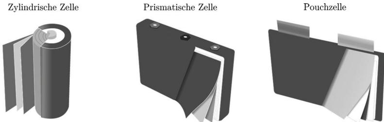
Abb. 2.2: Zellformate der Lithium-Ionen-Batterie<sup>70</sup>
