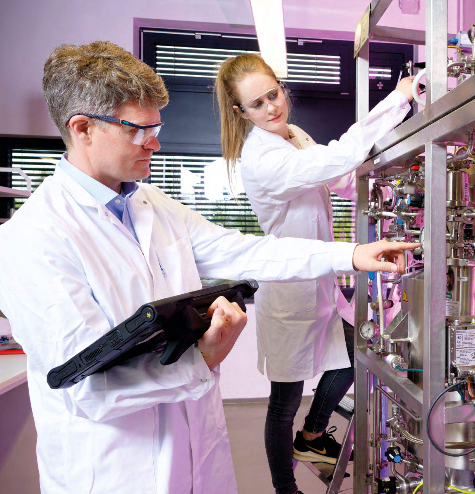
Bild 2: Digitales Leitsystem zur Remote Prozessüberwachung und -steuerung eines vollautomatisierten Druckreaktors
