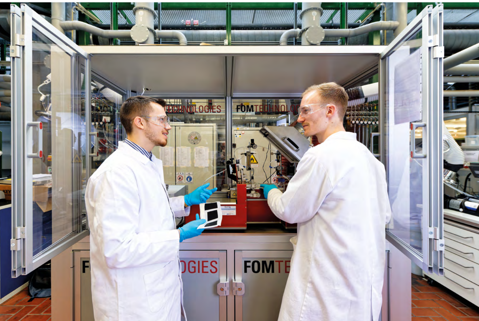
Bild 1: Mit Hilfe einer Breitschlitzdüse werden Membran-Elektroden-Einheiten mittels skalierbarer Technologie gefertigt.
