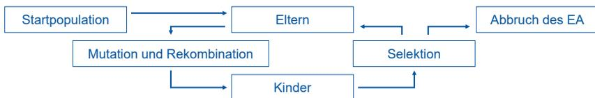
Bild 7.3: Schematischer Ablauf eines evolutionären Algorithmus nach [STRE19]
