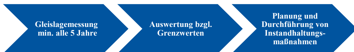
Abbildung 1: Bestehender Instandhaltungsprozess des Oberbaus im BOStrab-Bereich.
