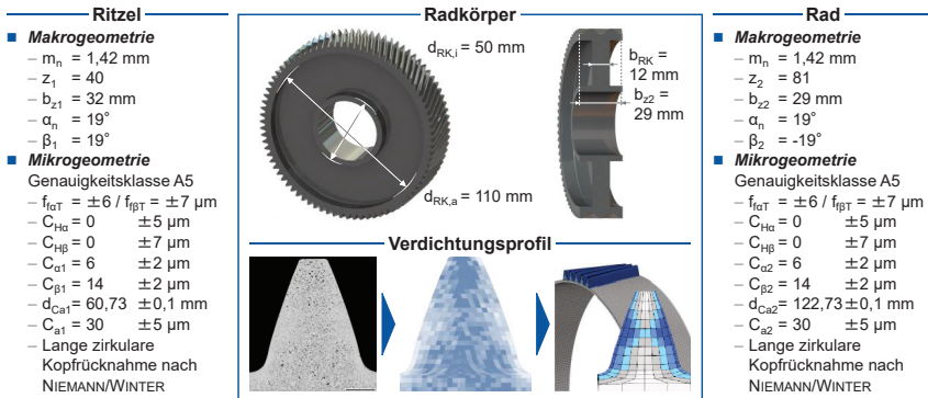
Bild 5-6: Makro- und Mikrogeometrie der Prüfverzahnung
