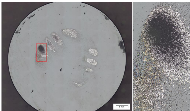
Abbildung 4-9: Beschädigung der DLC-Beschichtung eines Germaniumfensters durch direkte Drucklufteinwirkung, aufgenommen mittels Lichtmikroskop
