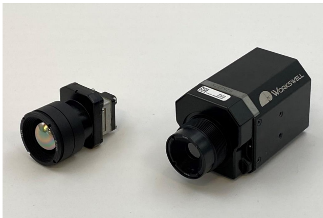
Abbildung 4-6: Boson Kamerakern mit VPC-Adapter (links) und Tau2 Kamerakern mit Workswell Modul (rechts)
