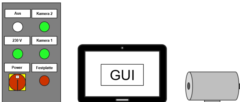
Abbildung 4-11: Schematische Übersicht über die Bestandteile (links: Kontrollbox, Mitte: Touchscreen-Monitor, rechts: IR-Kamera)
